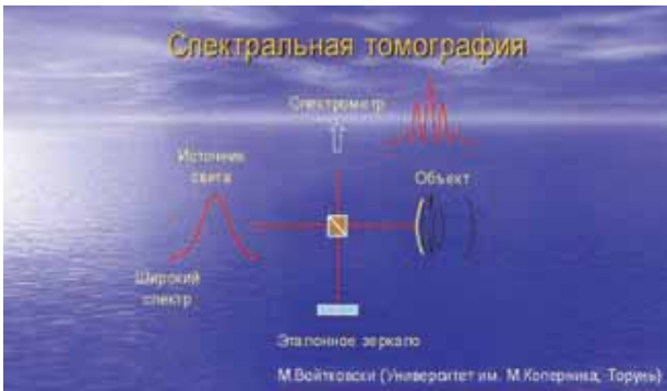
Рис. 1. Принцип работы спектральных томографов
